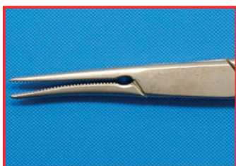
Deformação causada pelo manuseio inadequado
