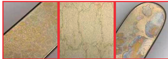
Descoloração típica de silicato sobre a superfície do instrumento, após a esterilização a vapor devido ao teor excessivo de ácido silícico na água dessalinizada.
