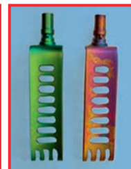
Recorte – Válvulas de Titânio: Válvula esquerda – nova Válvula direita – limpeza mecânica. Normalmente, a mudança de cor é uniforme. Porém, também pode ser manchada e de várias cores.
