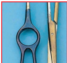
Instrumentos descoloridos por ácido silícico
