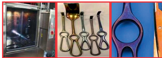
Manchas típicas de silicato na câmara de enxágue e na superfície do instrumento devido a limpadores com silicatos e teor excessivo de ácido silícico na água
