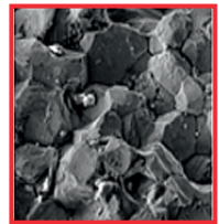
Detalhe: Gancho com típica estrutura de fratura intergranular solta.
