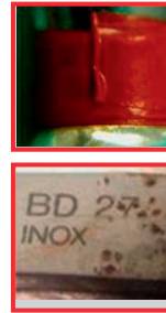
Pinça tomada por corrosão localizada Causa: Envelhecimento da fita colorida de codificação permite a infiltração de substâncias danosa, contendo cloretos.
