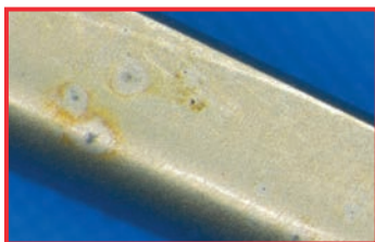
Corrosão localizada induzido por cloretos no instrumento
