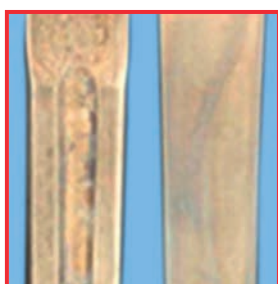
Superfícies descoloridas de cabos de bisturi
