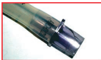
Trinca de tensão
