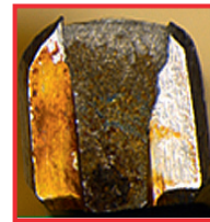
Detalhe: Gancho com típica estrutura de fratura intergranular solta.
