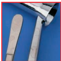
Manchas devido ao alto teor de sal na água de enxágue
