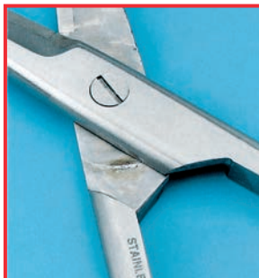
Corrosão por fricção devido à falta de conservação com óleo
