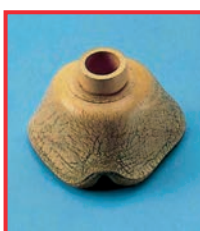
Fissura por envelhecimento em uma máscara respiratória
