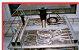
Carro injetor apropriado para a limpeza e lavagem de instrumentos oftalmológicos
