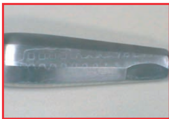
Arrasto de resíduos do agente de limpeza devido a enxágue insuficiente
