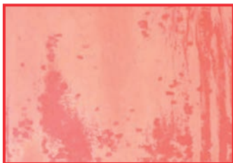
Mudança visual no alumínio anodizado colorido mesmo com pouca alcalinidade
