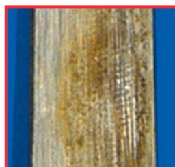
Perfurador de ossos, superfície de deslizamento do cursor mostra ocorrências de corrosão por atrito
