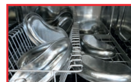
Carga errada / bandejas de inox tombadas
