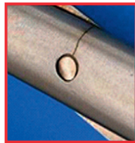
Detalhe: Articulação de trava de tesoura com fissura intercrystalina típica.
