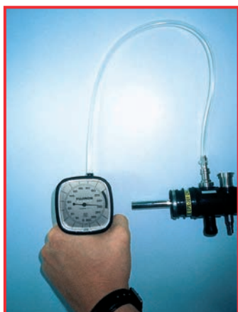
Teste de vazamento manual em um endoscópio flexível
