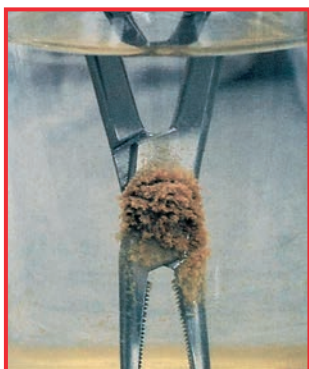
Corrosão causada pela imersão de várias horas em uma solução de soro fisiológico
