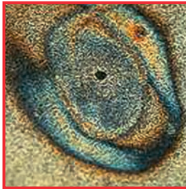
Delik korozyonu örneği
