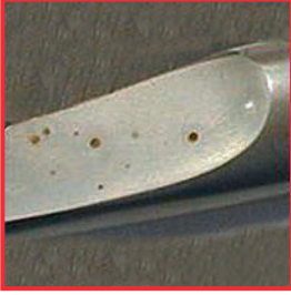
Alet üzerinde kloride bağılı delikli korozyon oluşumu.
