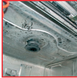
Aşırı kireçlenmiş yıkama bölmesi
