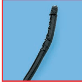
Uygunsuz bir bakım ürünü kullanıldığında içeri sokulan hortumda kabarma.
