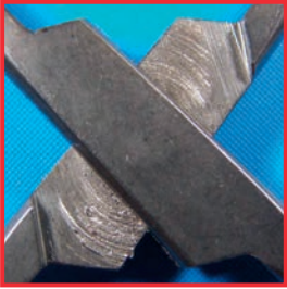
Yetersiz bakım ürünü kullanıldığı için metal aşındırıcılar
