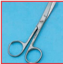
Delikli korozyonlu makas
