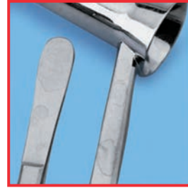
Sonuç: Kireç kalıntılı aletler
