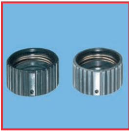
Resmin sağ tarafı: Siyah eloksal sertliği giderilmiş su tarafından istilaya uğraması.
