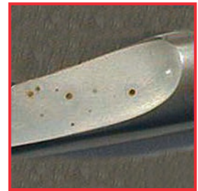
Delik korozyonu örneği
