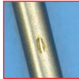
Temas sonucu korozyon: Paslanmaz çelik/paslanmaz çelik
