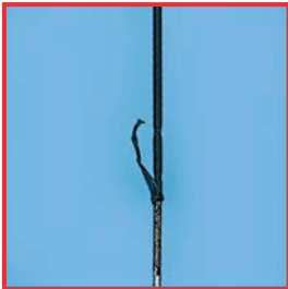
Bir HF aletinde zarar görmüş izolasyon
